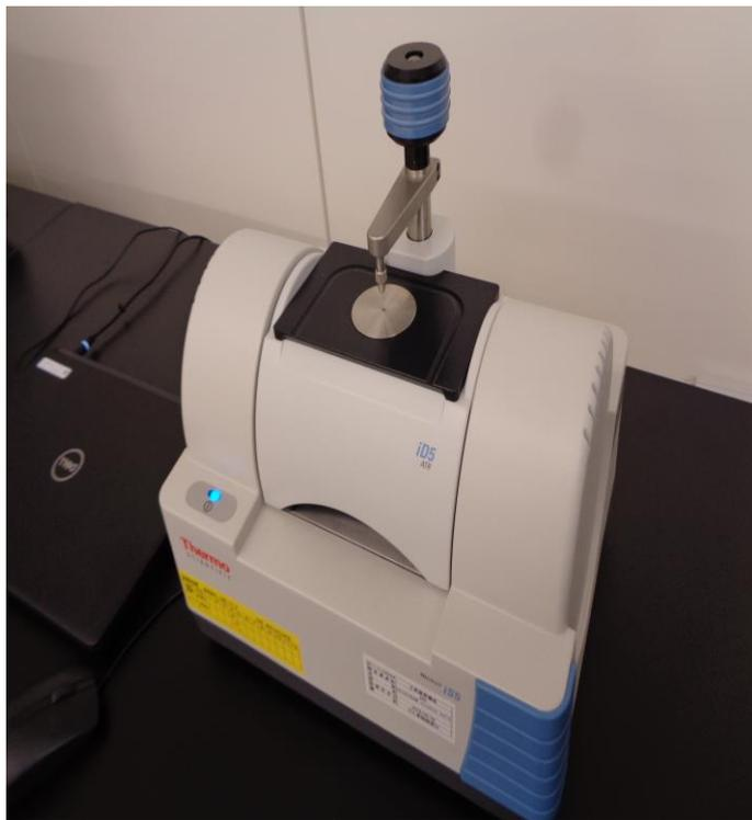
赤外分光光度計は、物質に赤外光を照射し、透過または反射した光を測定することで、検体の構造解析や定量を行う分析手法です。分子の振動や回転の状態を変化させるのに必要なエネルギー（赤外光の波長）は、物質の化学構造によって異なります。従って、物質に吸収された赤外光を測定すれば、化学構造や状態に関する情報を得ることができます。
