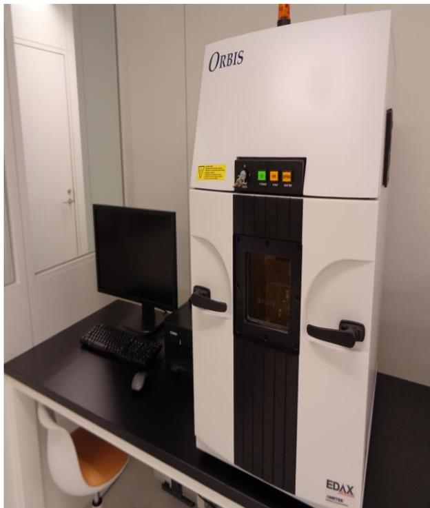
「蛍光X線分析装置（XRF：X-ray Fluorescence Analysis）」は、
