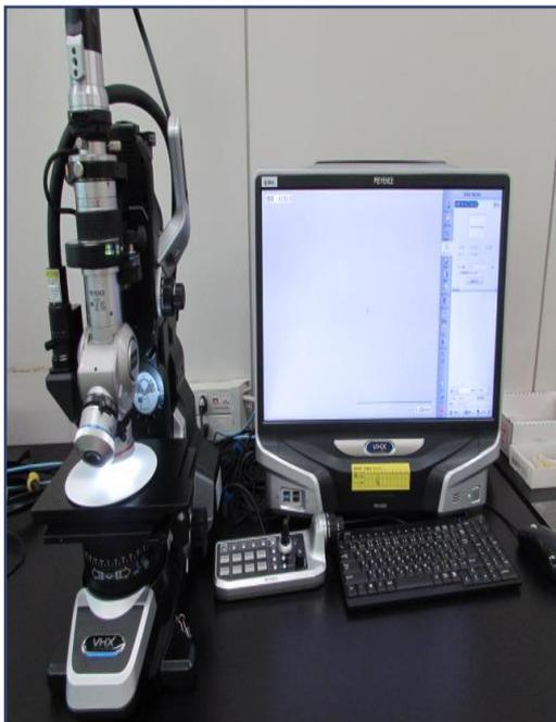
デジタルマイクロスコープとはデジタルカメラを搭載した顕微鏡です。光学顕微鏡のように接眼レンズを覗いて観察するのではなく、モニターに映した対象物をリアルタイムで複数人が同時に観察できます。これにより、スピーディーかつ詳細な検討が可能です。
