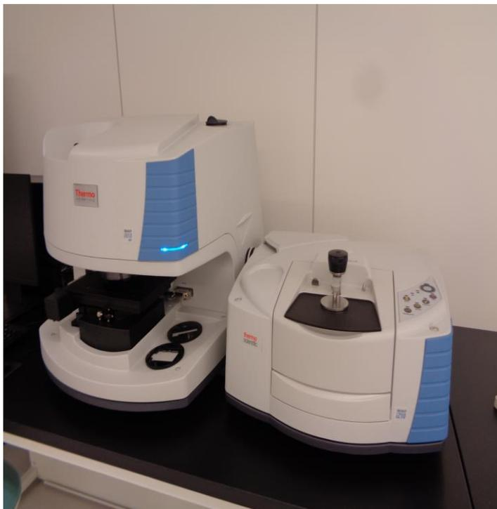
顕微 FT-IR は、光学顕微鏡の空間分解能力とFT-IRスペクトルで判別できる豊富な化学情報を組み合わせる事により、マイクロプラスチック、各種製品の清浄度や表面性状などにおける視覚的な検査だけでなく、発見された粒子や異物など目に見えないような微量試料を化学的に定性できる最新の分析機器です。
